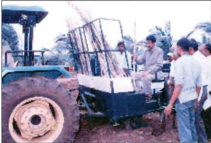
شکل ۱: قلمه کار نیشکر مجهز به دستگاه برش در حال انجام کار
