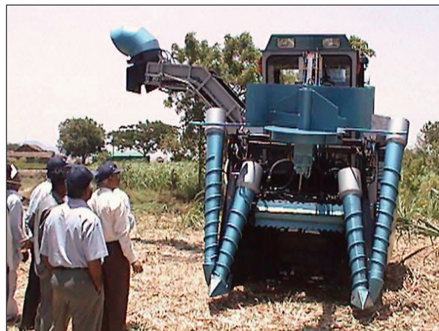
شکل ۲: هاروستر بومی نیشکر - ماشین (هاروستر) تحت یک عملیات گسترده مزرعه‌ای در حال آزمایش است
